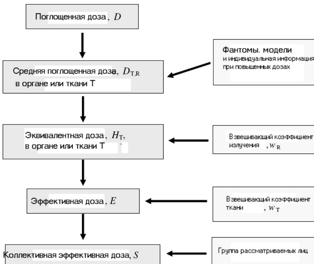
Рис. В.1. Система дозовых величин, используемых в радиационной защите
